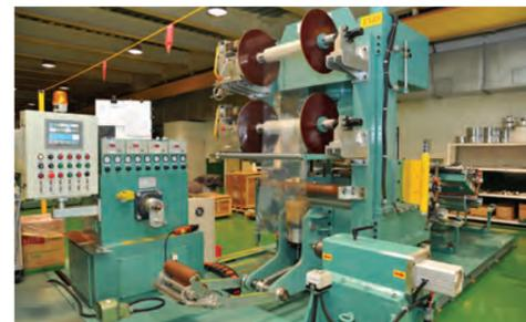
低壓線圈繞線設備
