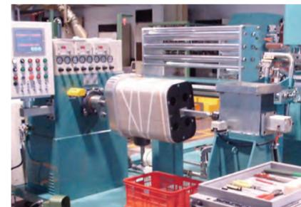
高壓線圈繞線設備
