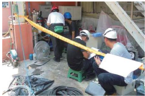
廠商執行固定污染源檢測作業情形
